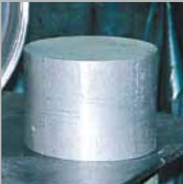
Das Ausgangsmaterial ist ein Billet aus hochwertigem Aluminium
