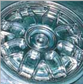
Nach der dritten Umformung ist das Rad fertig für die maschinelle Bearbeitung
